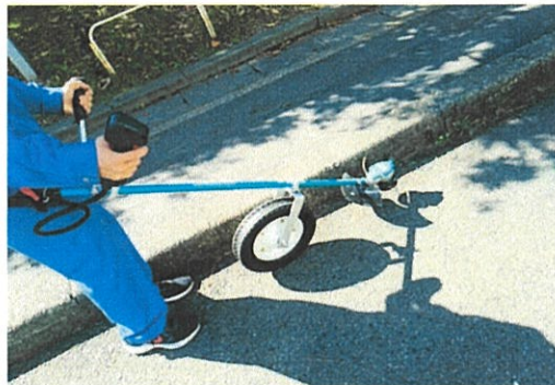
図 27 手押し式刈払機の試運転
