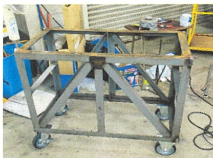
図 9 廃材を利用したフレーム
