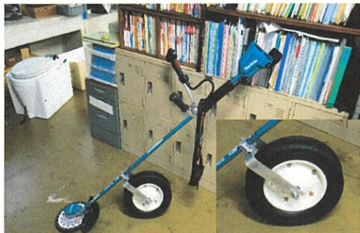
拡大部分の車輪は着脱式である。 図 26 作成した手押し式刈払機
